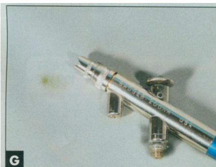
Bei 7 psi (0,5 bar), dem niedrigsten Druck, kommt Farbe aus der Pistole heraus, ein einzelner Punkt sieht etwas ungleichmäßig aus.
