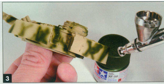
3 Für feine Tarnlinien auf einem PzKpfw IV – Turm setzt Aaron den Druck bis auf 1,5 psi (1,0 bar) herab. Man spritzt Weniger Farbe, deshalb fallen kleinere Fehler nicht so auf.
