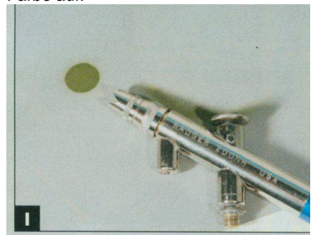
Der Punkt bei 30 psi (2,07 bar) sieht mehr aus wie eine Pfütze, ein sicheres Zeichen für zu viel Farbe.
