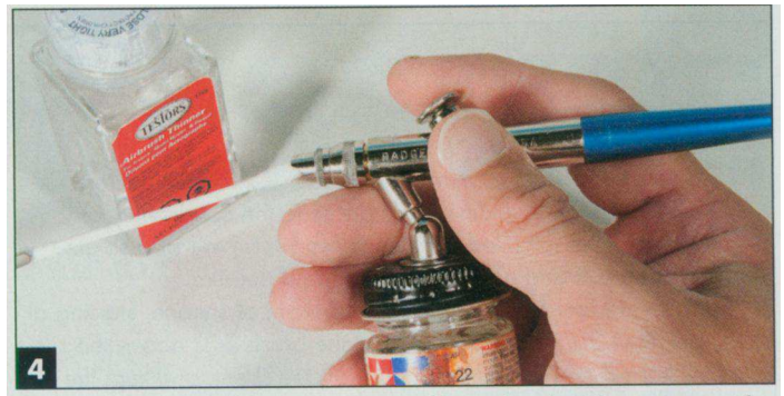
4 Aaron entfernt angetrocknete Farbe aus der Spitze der Pistole mit einem Wattestäbchen getränkt mit Verdüner. Aber vorsichtig, um die Nadel nicht zu beschädigen.
